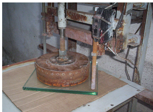
Figura 2 – Máquina projetada para corte dos vidros
