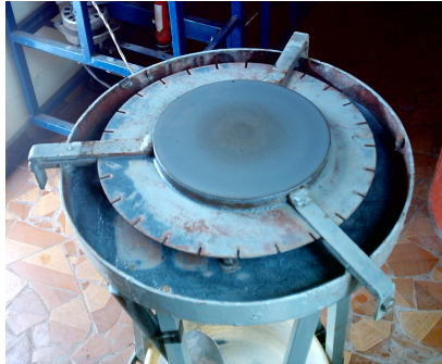
Figura 3 – molde metálico para esmerilhamento do vidro.
