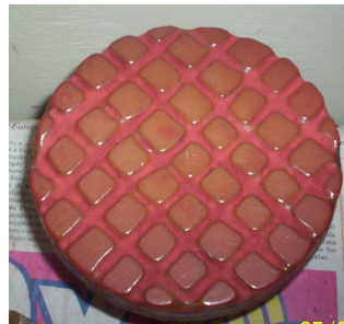
Figura 4 – torta de breu utilizada no processo de polimento
